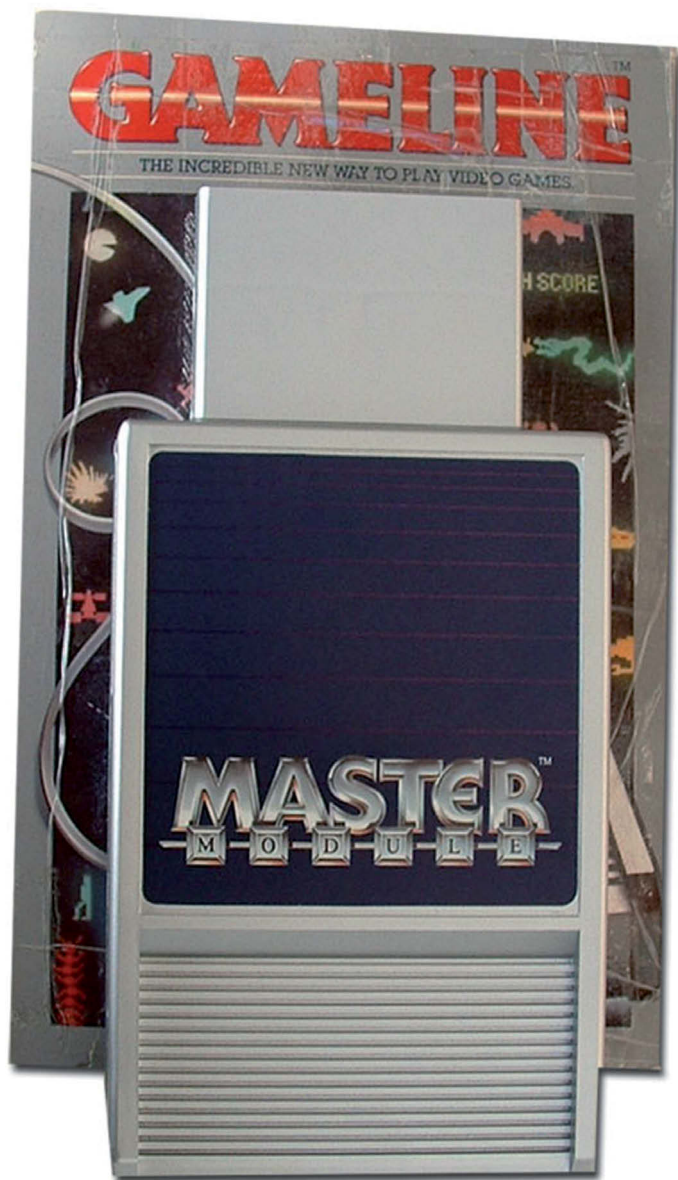
Master Module Modem, o componente principal do GameLine. Fonte: Atarimania.COM
