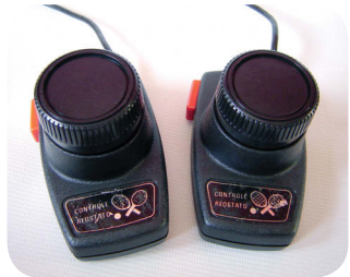
Controle do tipo paddle que acompanhava o videogame. Interessante uso da palavra 'reostato'. Foto: Leandro Camara
