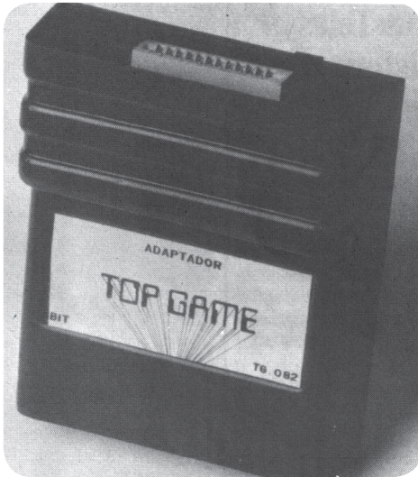
Adaptador para que o Top Game pudes- se ser usado com cartuchos do padrão Atari. Fonte: Revista Micro & Vídeo
