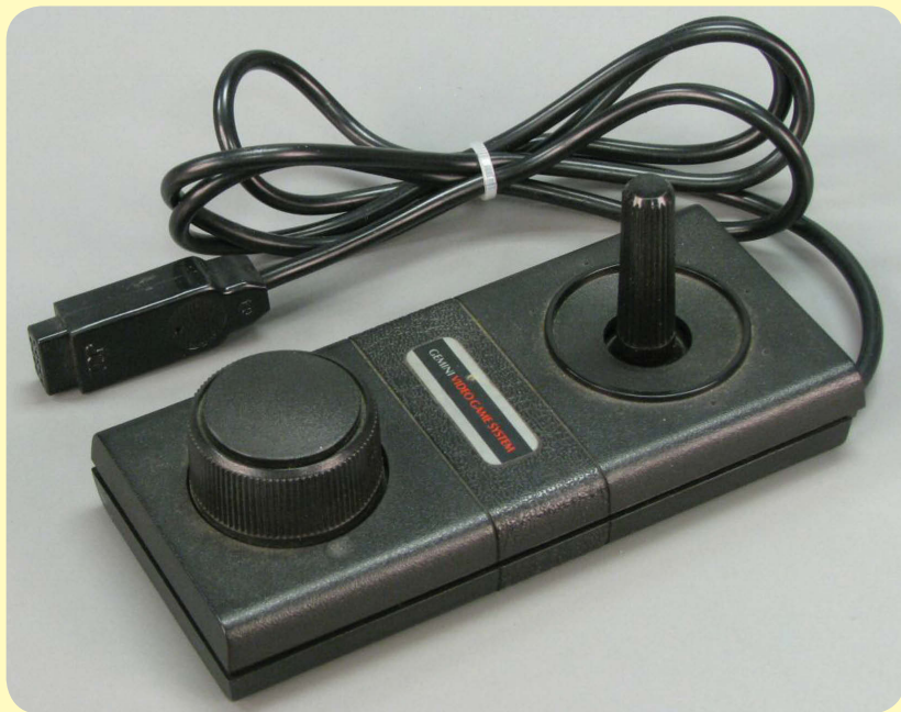
Controle original do Gemini da Coleco. Joystick e Paddle no mesmo dispositivo. Fonte: Thestrong.org
